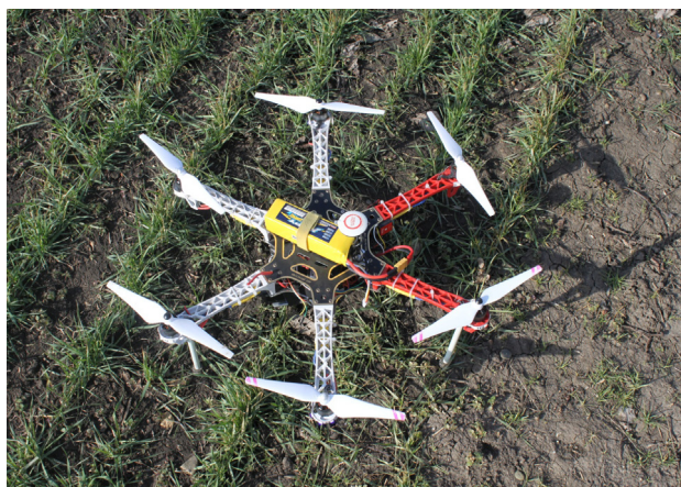
Рис. 1. Беспилотный гексакоптер «ФитоСан 1а» (общий вид)
