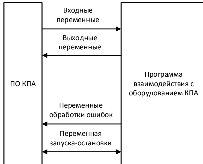
Рис. 2. Схема информационного обмена ПО КПА с программами взаимодействия с оборудованием
