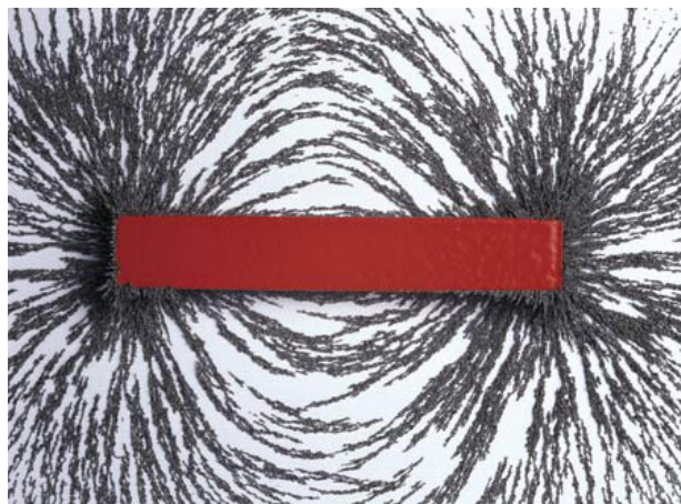
Рис. 2. Взаимодействие металлических ферромагнитных частиц с полем постоянного магнита
