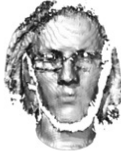
Рис. 2. Карта глубины лица, получаемая с помощью сенсора Intel RealSense
