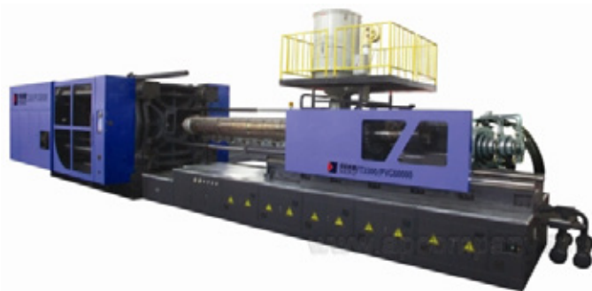
Рис. 1. Термопластавтомат для производства крупногабаритных пластиковых изделий SOUND (Китай)
