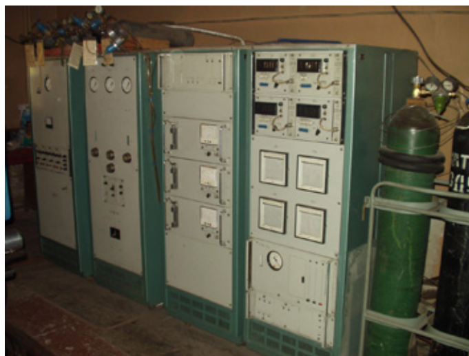
Рис. 2. Общий вид системы газового анализа АСГА-Т
