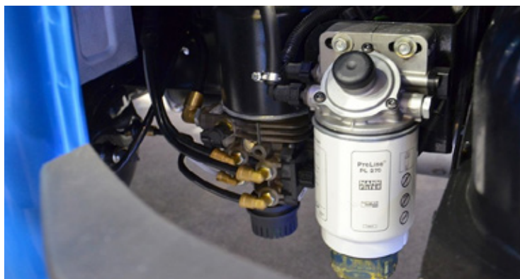
Рис. 1. Сепаратор MANN+HUMMEL PreLine 270, установленный на грузовом автомобиле ГАЗон NEXT
