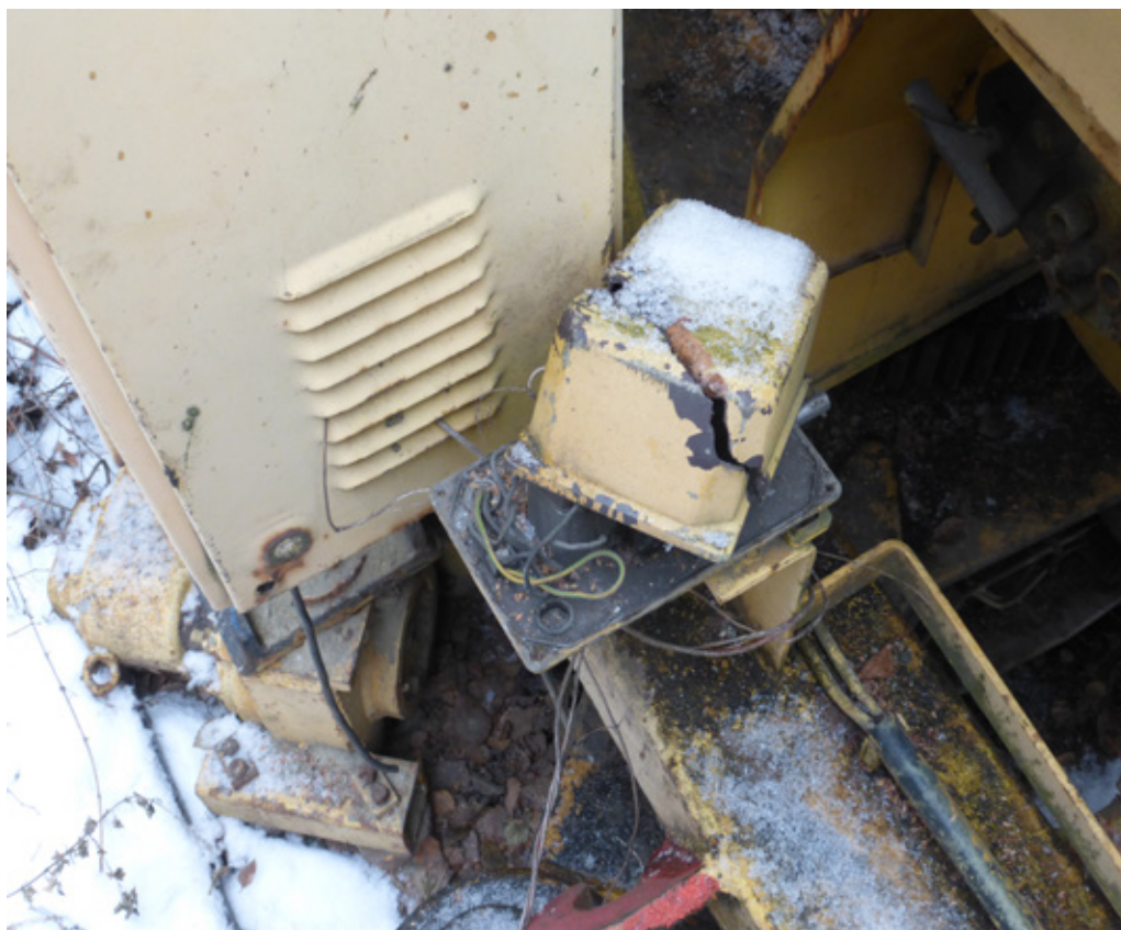
Рис. 1. Разрушение металлоконструкций башенного крана (Liebherr)
