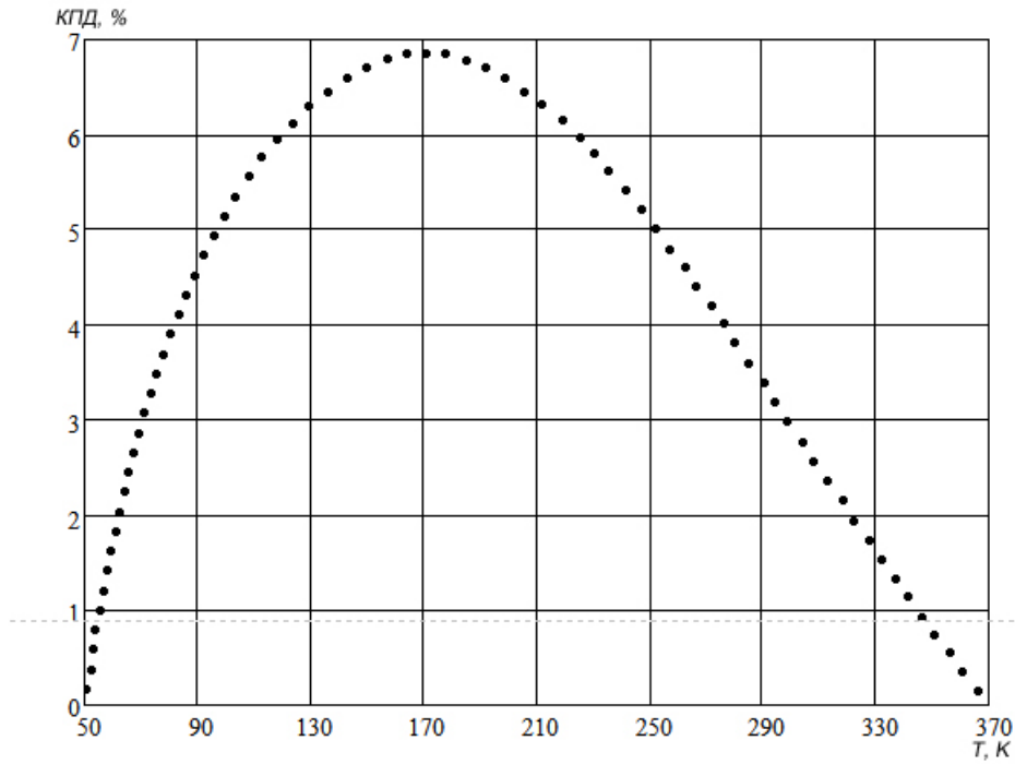
Рис. 4. Зависимость (КПД) ТЭМ на основе (Bi 2 Te 3 ) от градиента температур между холодной и горячей стороной
