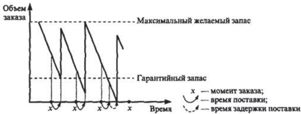
Рис. 2. Движение запасов в системе управления запасами с фиксированным интервалом времени между заказами
