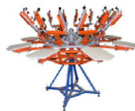
Рис. 7. Карусельный печатный станок с восемью точками нанесения трафарета
