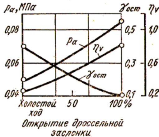
Рис. 1. Зависимость давления p_\alpha и коэффициентов \gamma_{ост} и \eta_v от нагрузки карбюраторного двигателя
