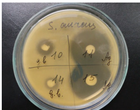
Рис. 5. Определение зон отсутствия роста Staphylococcus aureus
