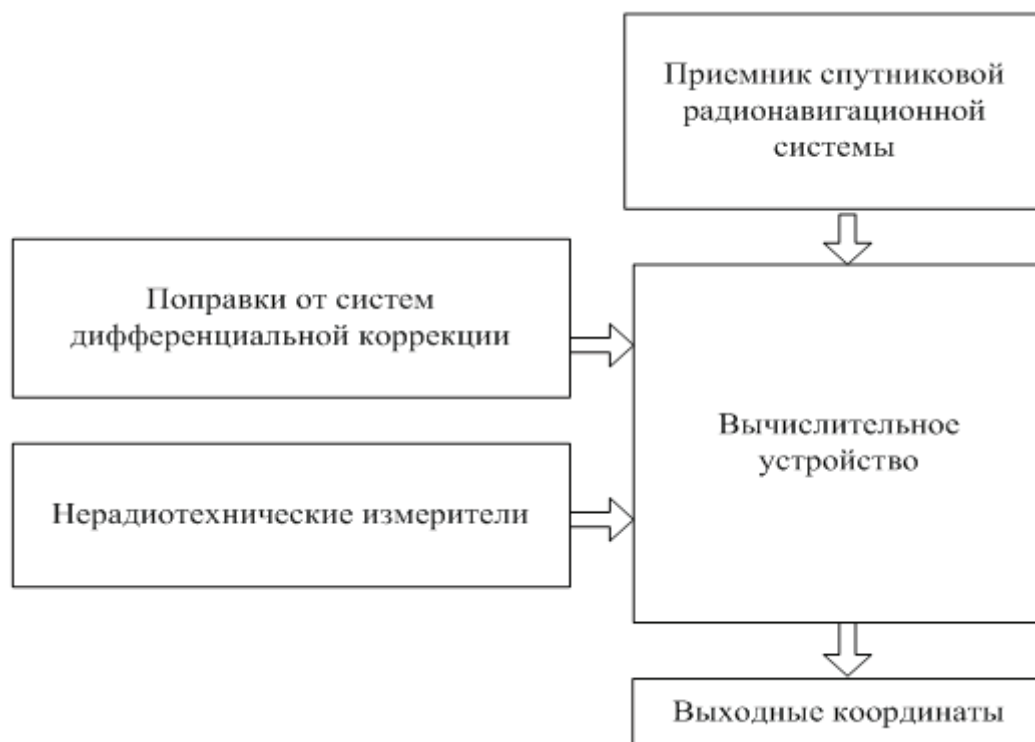
Рис. 2. Структурная схема системы навигации для ПНО иностранного производства
