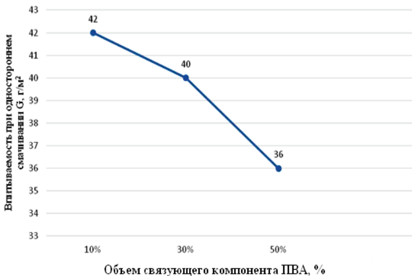
Рис. 2. Зависимость впитываемости готовой продукции от процентного соотношения объема ПВА к объему меловальной суспензии
