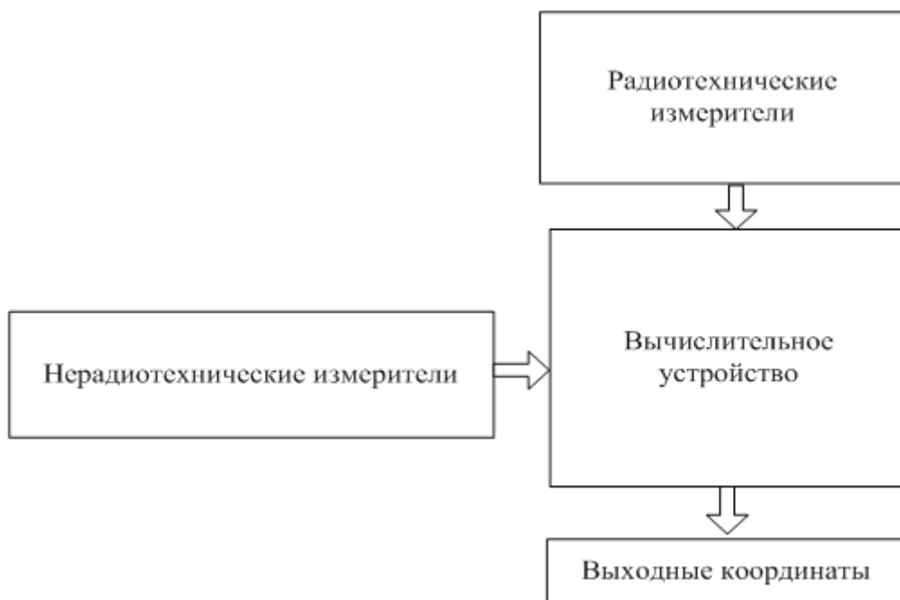
Рис. 1. Структурная схема системы навигации для ПНО отечественного производства
