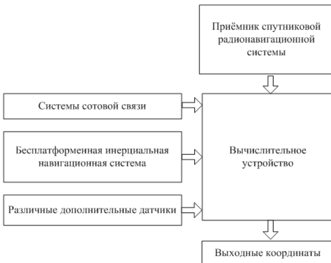
Рис. 1. Наиболее перспективный состав системы навигации для ПНО
