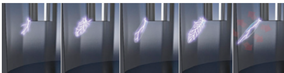
Рис. 1. Прорастание стримеров в межэлектродном пространстве
