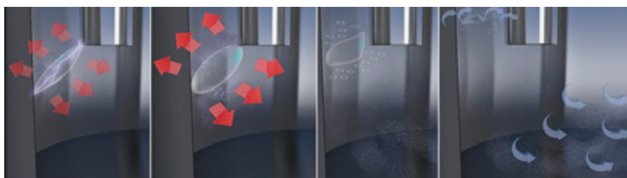
Рис. 2. Образование кавитационной полости и возникновение течения в жидкости
