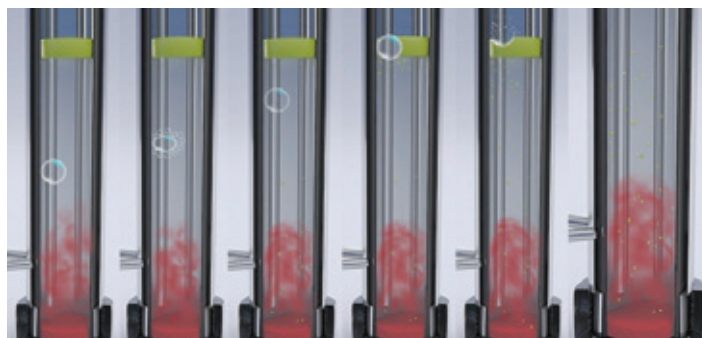
Рис. 3. Процесс схлопывания кавитационной полости
