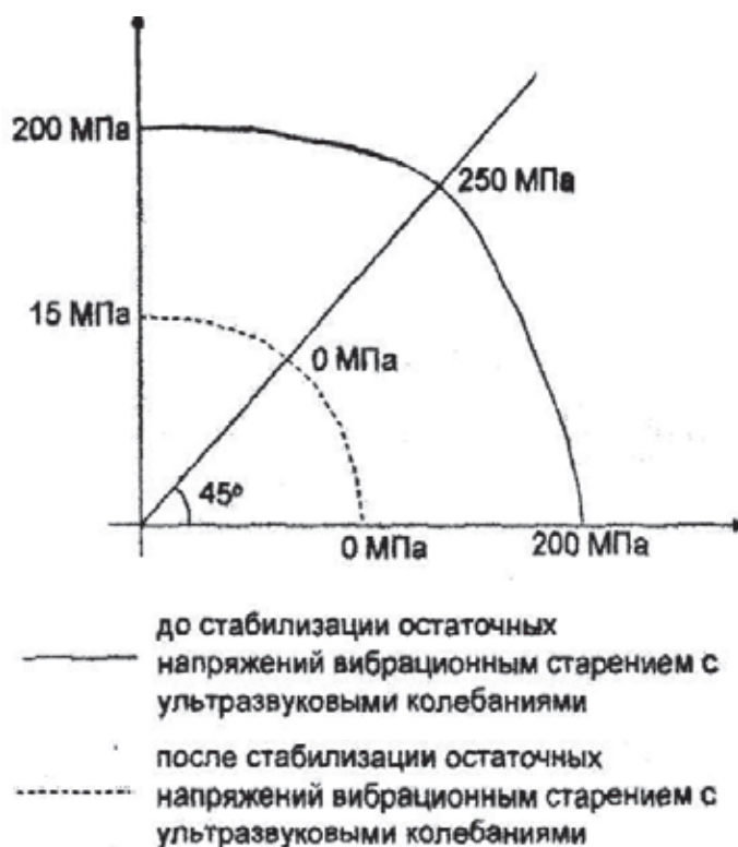
Рис. 3. График стабилизации остаточных напряжений в золотнике ультразвуковой обработкой
