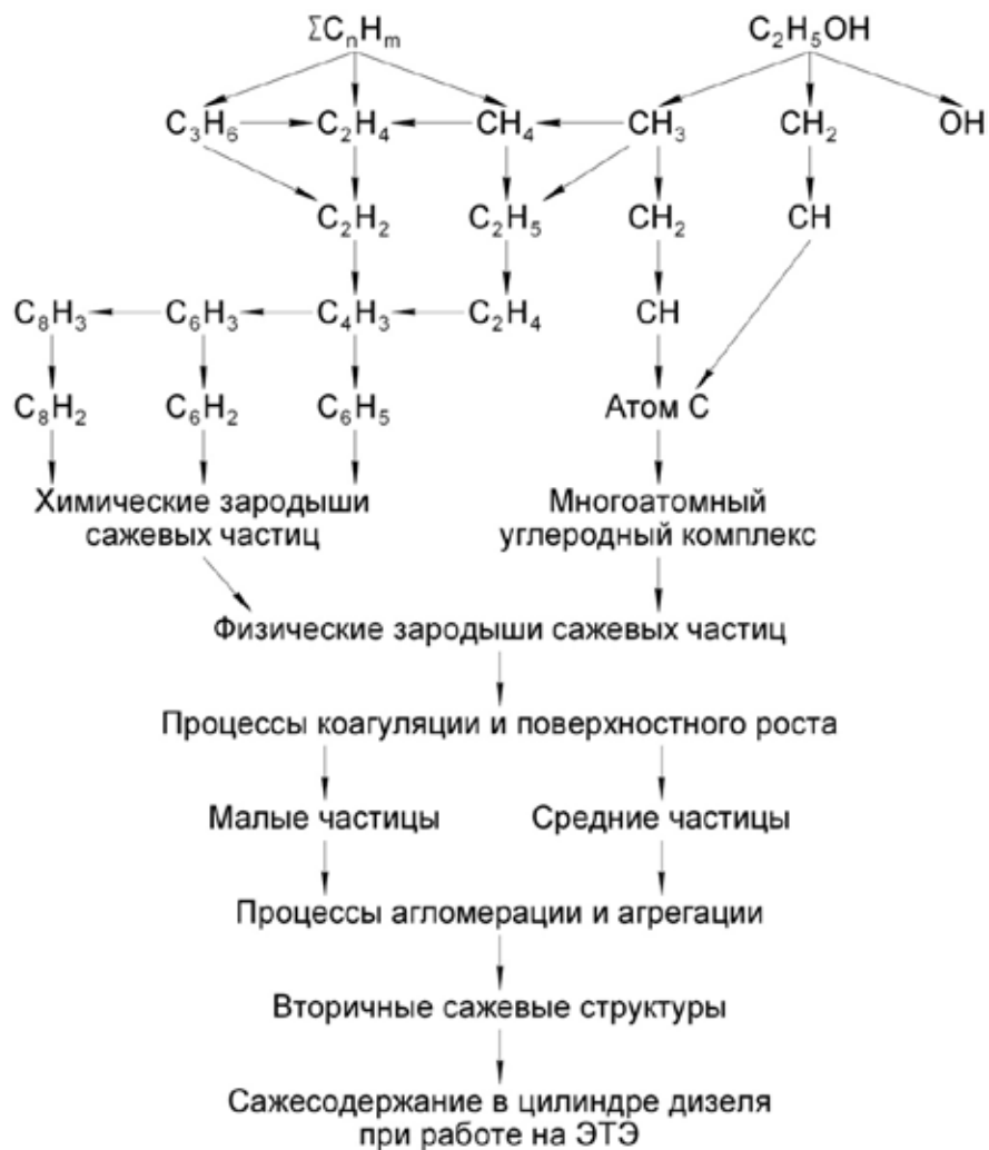
Рис. 1. Химизм процесса образования сажи в цилиндре дизеля 4С 11,0/12,5 при работе на этано-топливной эмульсии
