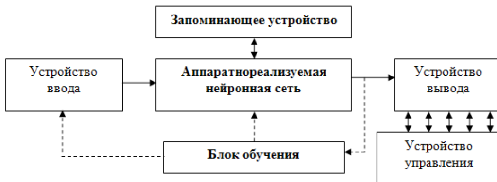
Рис. 2. Структурная схема абстрактного нейрокомпьютера
