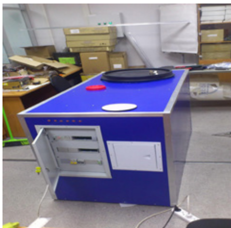
Рис. 1. Промышленный внешний вид камеры соляного тумана
