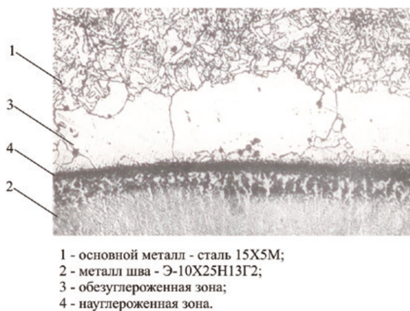
Рис. 3. Сварное соединение трубопровода из стали 15X5M с аустенитным швом типа Э-10X25Н13Г2
