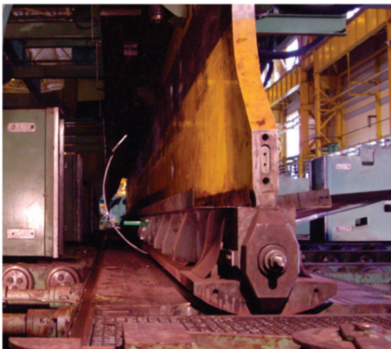
Рис. 1. Формовка стальной заготовки на трубном прессе
