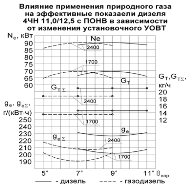
Рис. 1. Влияние применения ПГ на эффективные показатели дизеля 4ЧН 11,0/12,5 с ПОНВ в зависимости от изменения установочного УОВТ при n = 2400 \text{ мин}^{-1} , p_e = 0,947 \text{ МПа} , и n = 1700 \text{ мин}^{-1} , p_e = 1,036 \text{ МПа} : — — — дизельный процесс, — — — газодизельный процесс
