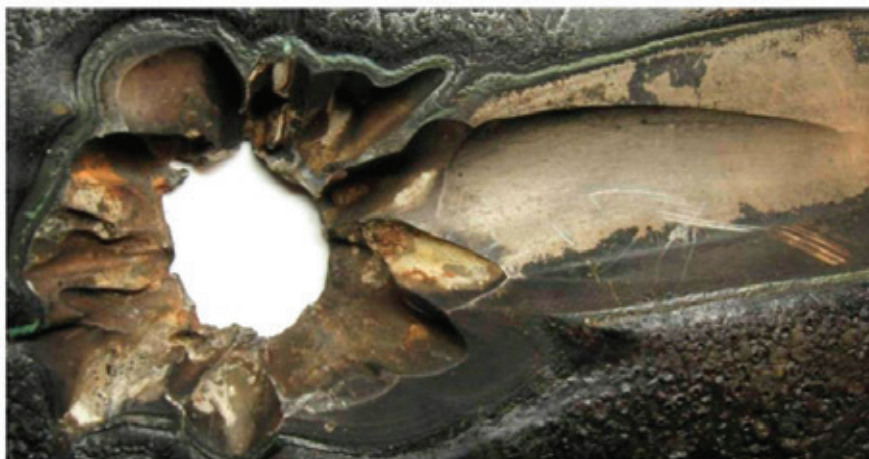
Рис. 2. Дефект раскатной пригар разорванной трубы
