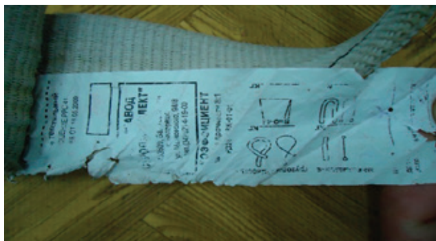
Рис. 1. Нечитаемые сведения на бирке и двусторонние поперечные разрывы ленты
