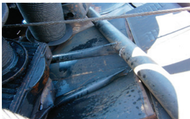
Рис. 5. Разрушения и недопустимые деформации поворотной платформы
