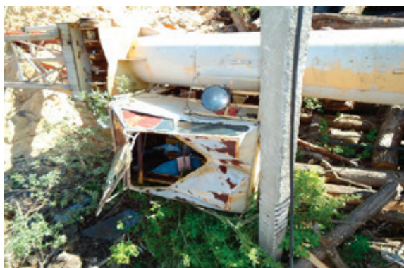
Рис. 6. Разрушения и недопустимые деформации кабины и стрелы
