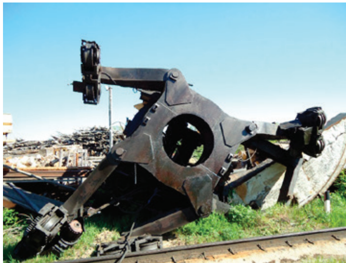
Рис. 2. Авария башенного крана КБ-100.3Б
