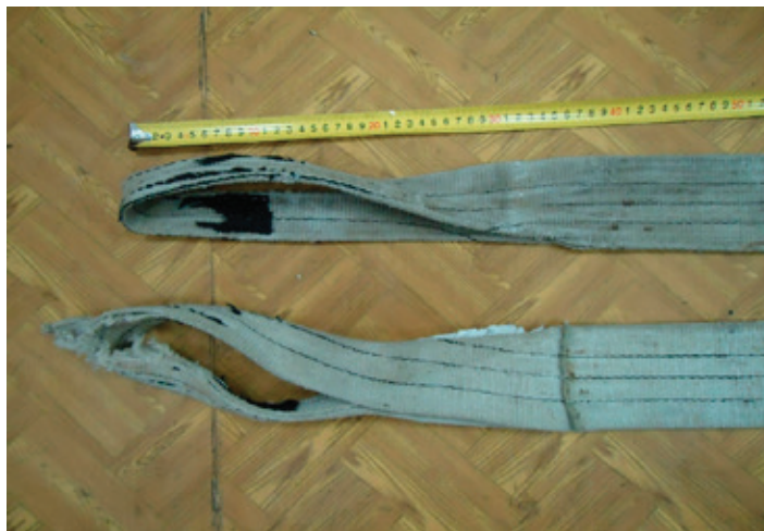
Рис. 3. Поперечный разрыв второй петли стропа на длине равной 50% от ширины петли
