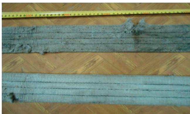
Рис. 2. Односторонний поперечный разрыв ленты
