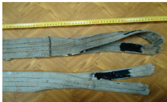
Рис. 1. Нечитаемые сведения на бирке и двусторонние поперечные разрывы ленты
