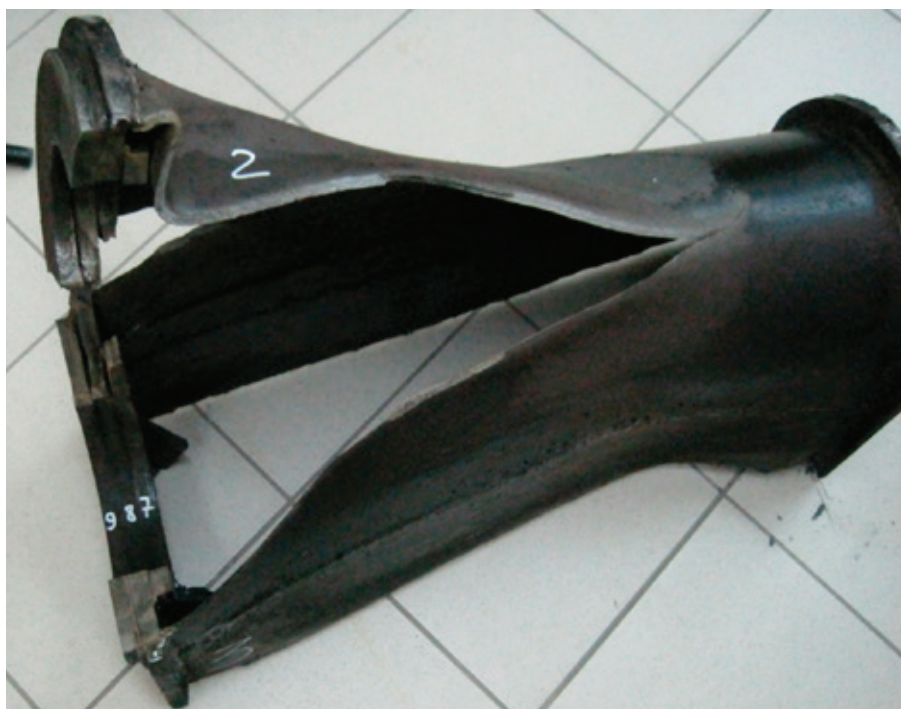
Рис. 1. Зона разрушения флюгера ходовой рамы крана
