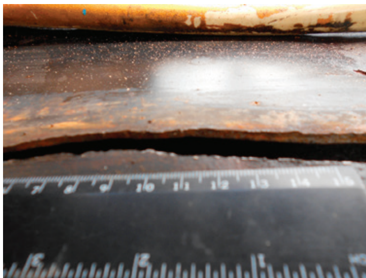
Рис. 2. Края вырванного металла
