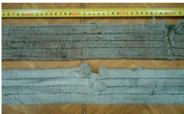
Рис. 2. Односторонний поперечный разрыв ленты
