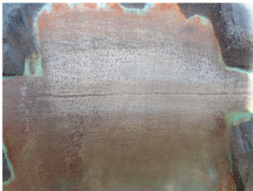
Рис. 2. Дефект риска на поверхности стальной трубы большого диаметра
