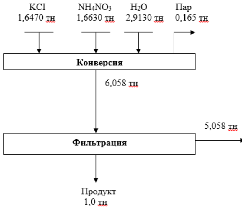
Рис. 4. Материальный баланс получения нитрата калия конверсионным методом из хлорида калия Тюбегатанского месторождения и нитрата аммония местного производства.
