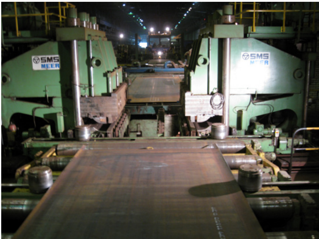
Рис. 2. Кромкогибочный пресс SMS Meer
