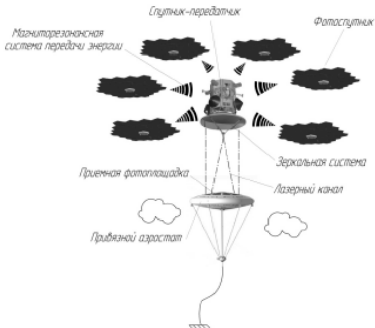
Рис. 6. Схема построения кластерной фрагментарной солнечной космической электростанции [17, с. 194]
