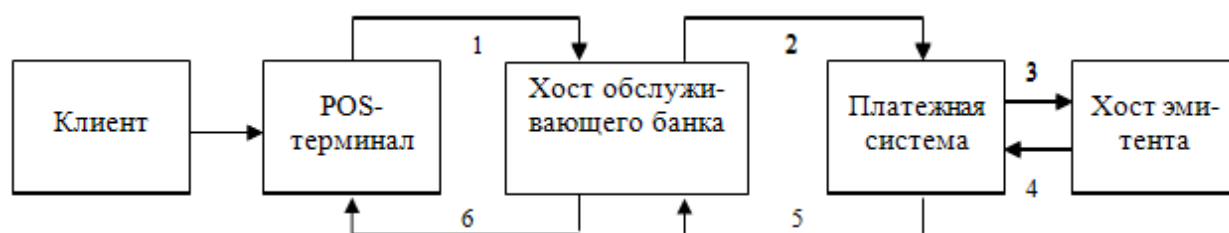
Рис. 2. Алгоритм осуществления проверки при транзакции по банковским картам
