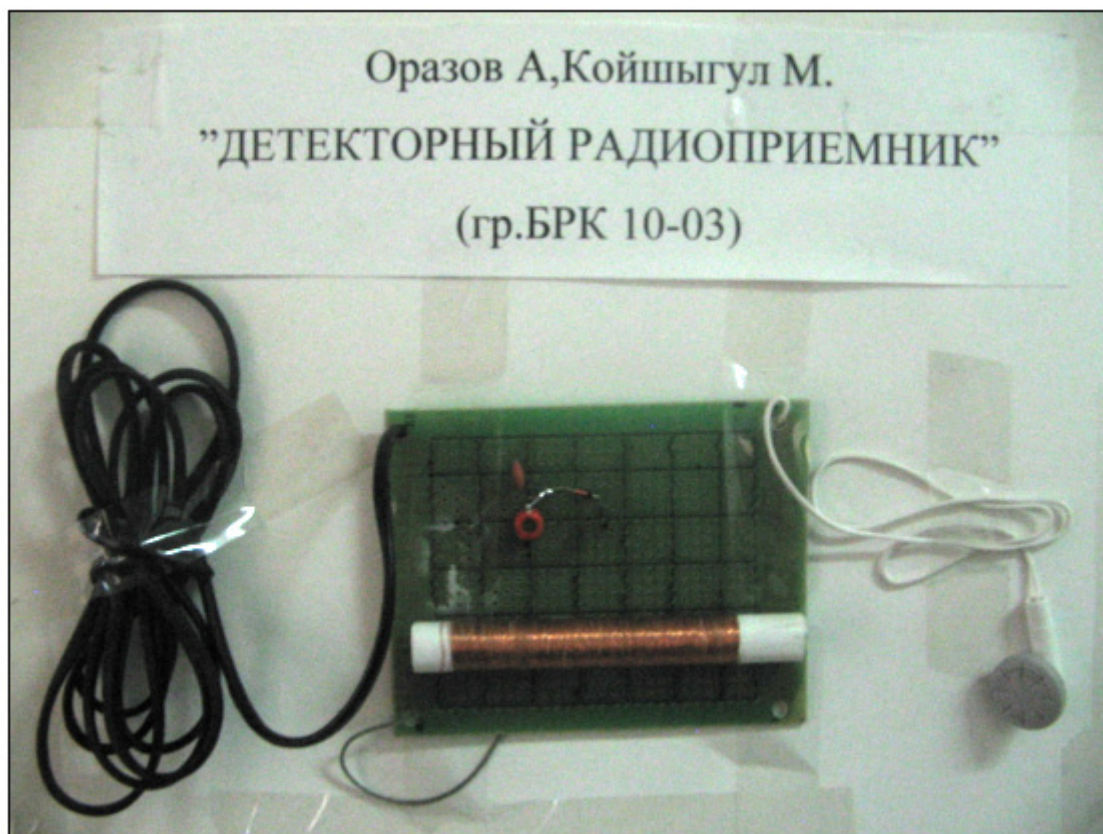
Рис. 5. Плата детекторного радиоприемника, изготовленная студентами
