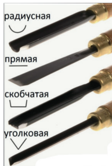
Рис. 1. Виды штихелей (резцов) для линолеума
