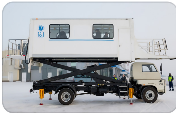
Рис. 1. Амбулифт для посадки/высадки инвалидов
