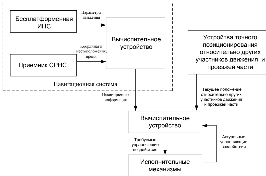
Рис. 1. Структурная схема САУ автомобиля
