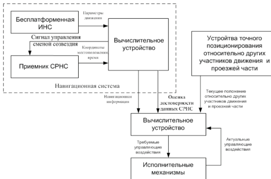
Рис. 3. Перспективная структурная схема САУ автомобиля
