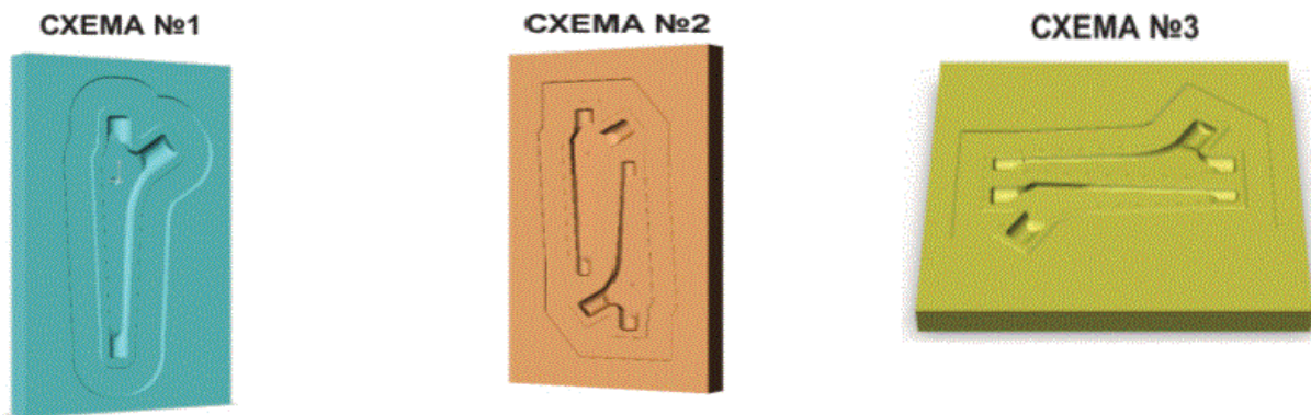
Рис. 2. Трехмерные модели вкладышей штамповых вставок (схема № 1 — единичная, схема № 2 — спаренная с внутренним расположением отростков, схема № 3 — спаренная с внешним расположением отростков)
