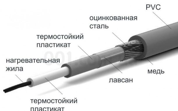
Рис. 8. Конструкция нагревательного провода
