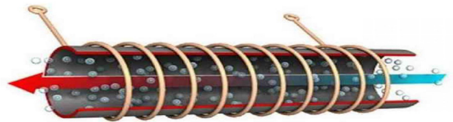
Рис. 13. Индукционный прогрев бетона
