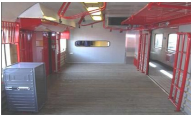
Рис. 5. Вагон для перевозки багажа и грузобагажа (интерьер)
