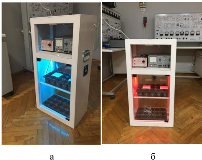
Рис. 2. Общий вид модели предлагаемой биотехнологической установки: а — с синим спектром освещения; б — с красным спектром освещения
