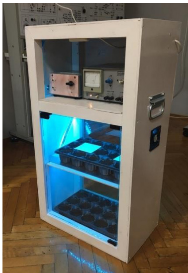
Рис. 3. Общий вид биотехнологической установки с предлагаемой системой досвечивания
