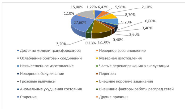
Рис. 4. Определение причин повреждения силовых трансформаторов
