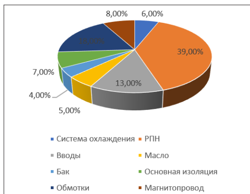
Рис. 2. Гистограмма повреждения основных узлов силовых трансформаторов за границей
