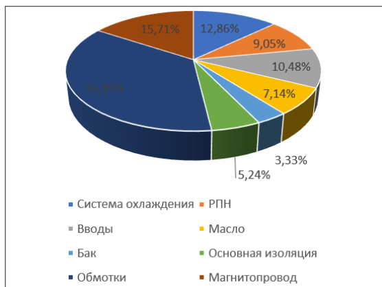
Рис. 1. Гистограмма повреждения основных узлов силовых трансформаторов в России
