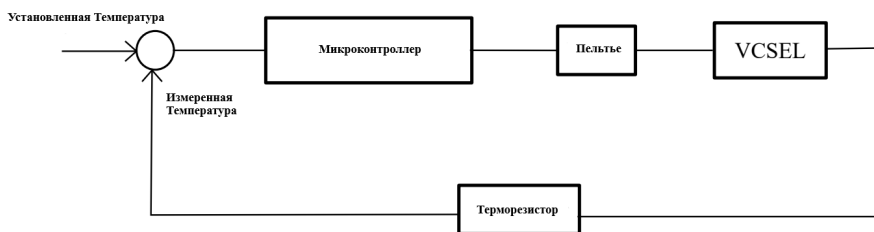
Рис. 7. Блок-схема используемого регулятора температуры
