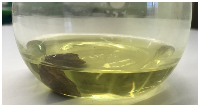
Рис. 11. В азотной кислоте железо выделилось из тестируемого метеорита, окрасив раствор в светло-жёлтый цвет нитрата железа (III)
