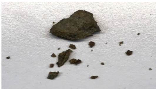
Рис. 18. Образец ломается и крошится, так как все металлы перешли в нитраты
