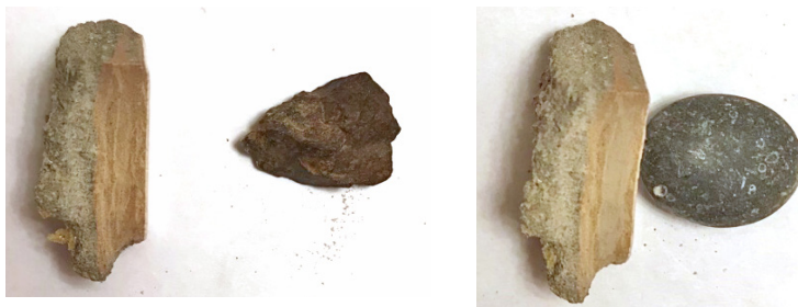
Рис. 10. Тест на прочность. Метеорит поцарапал плитку, не окрасив её. Камень оставил следы крошки на поверхности
