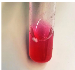
Рис. 17. Диметилглиоксимат никеля в растворе
