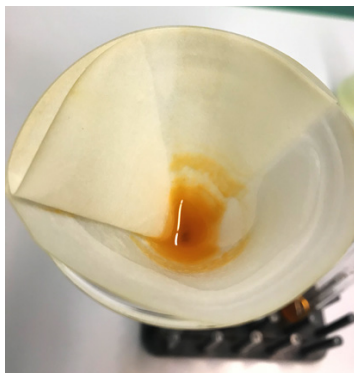
Рис. 14. Жёлтый желеобразный осадок фторида железа на фильтре
