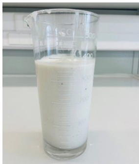
Рис. 1. Трехфазный пенный полимерный раствор
