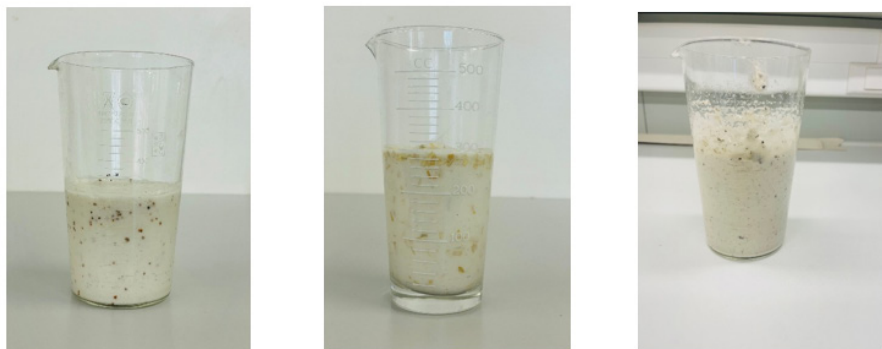
Рис. 2. Пенный полимерный раствор с наполнителями: скорлупа грецкого ореха (а), измельченная солома (б) и хлопковая шелуха (в)
