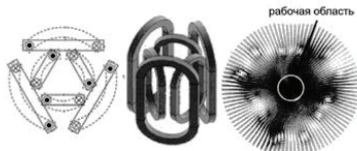
Рис. 4. Схема обмоток и распределение магнитного поля сверхпроводящего индуктора
