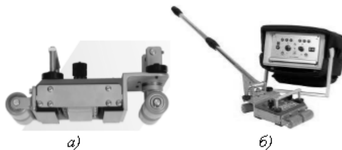
Рис. 9. Восемнадцатиканальный ручной преобразователь для контроля плоских поверхностей: а) вид снизу; б) вид в сборе с блоком контроля
