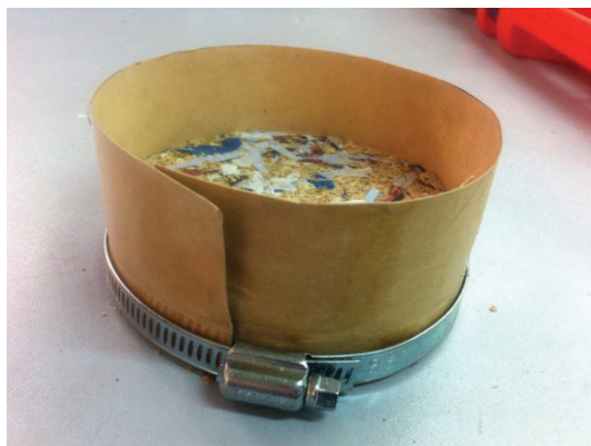
Рис. 2. Раздвижной хомут с электроизоляционным картоном ЭВТ
