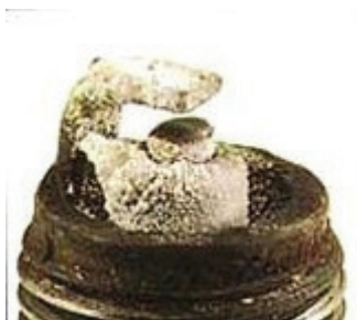
Рис. 4. Центральный и боковой электроды покрыты налётом пепельного цвета
