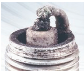
Рис. 7. Наличие на тепловом конусе свечи зажигания нагара белого цвета и соединение электродов с помощью продуктов сгорания и плавления металлов
