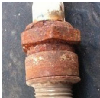
Рис. 11. Коррозия корпуса свечи зажигания
