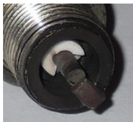
Рис. 12. Нижняя часть корпуса свечи зажигания. Механическое повреждение
