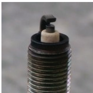
Рис. 2. Нормально работающая свеча зажигания
