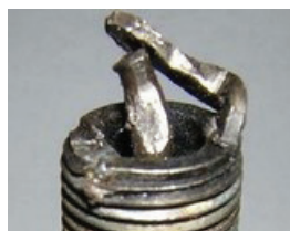
Рис. 13. Механическое повреждение свечи зажигания
