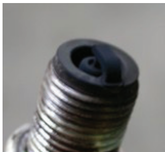
Рис. 3. Катод центрального электрода, покрытый бархатисто-чёрными остатками продуктов сгорания
