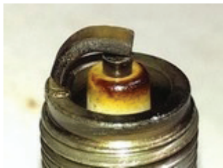
Рис. 8. Активно протекающая реакция свинца с выступающей вокруг центрального электрода металла свечи зажигания
