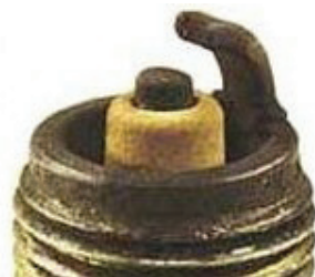
Рис. 9. Активно протекающая реакция свинца с боковым электродом
