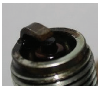
Рис. 6. Влажные, чёрные масляные отложения на кончике юбки и электродов
