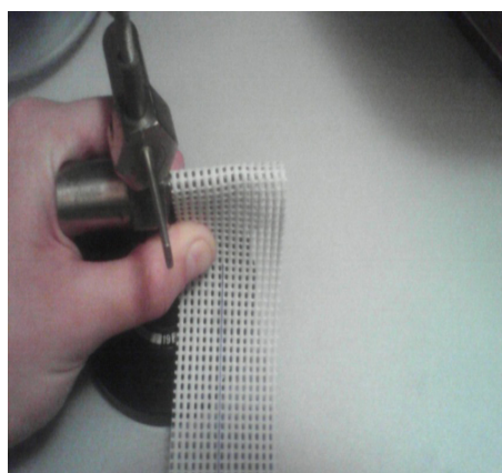
Рис. 3. Определение гибкости полотна при минус 20°С
