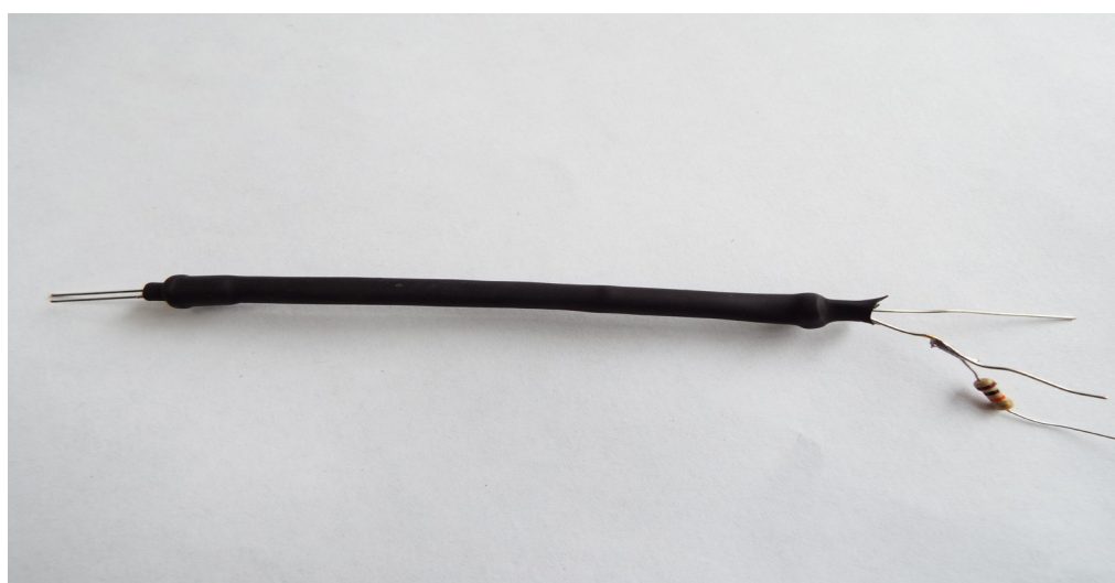
Рис. 8. Датчик изгиба в сборе (2 версия)
