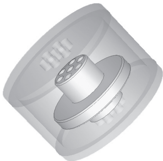
Рис. 1. 3d-модель первой конструкции резонатора
