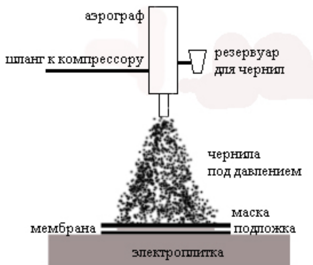
Рис. 1. Схема нанесения каталитического слоя методом распыления под давлением
