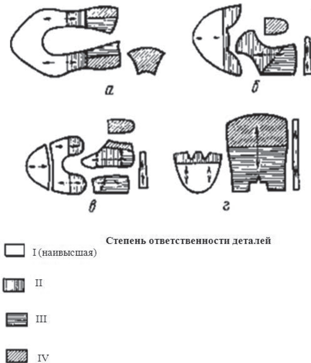
Рис. 1. Степень ответственности участков наружных деталей верха обуви: а — туфля типа лодочки; б — полуботинок с накладными берцами; в — ботинок с накладной союзкой; г — сапог с целыми голенищами
