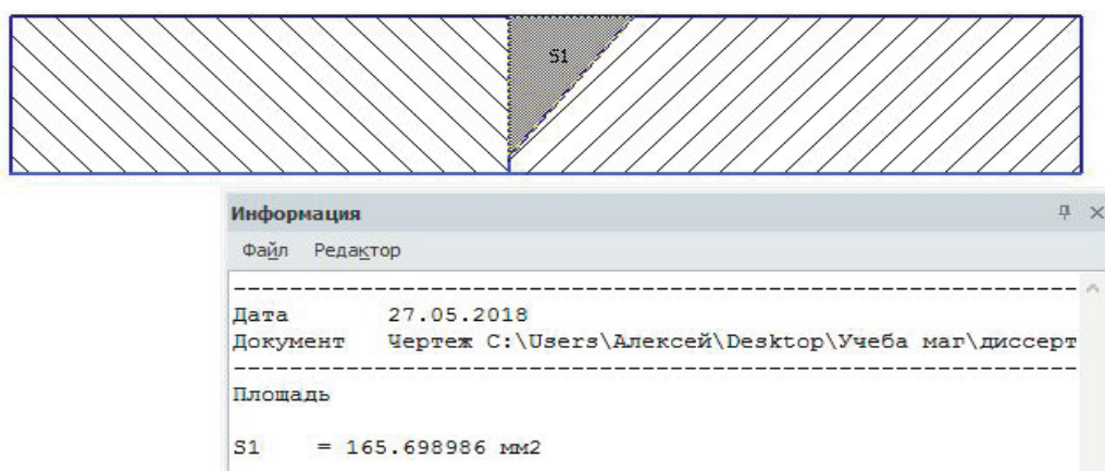
Рис. 2. Форма разделки кромок образца 2. Имитирующий соединение корпус-секция
