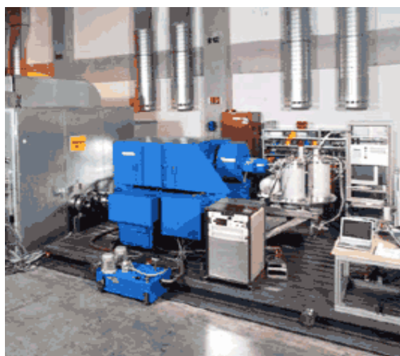
Рис. 5. Синхронный ВТСП генератор Siemens мощностью 4 МВт
