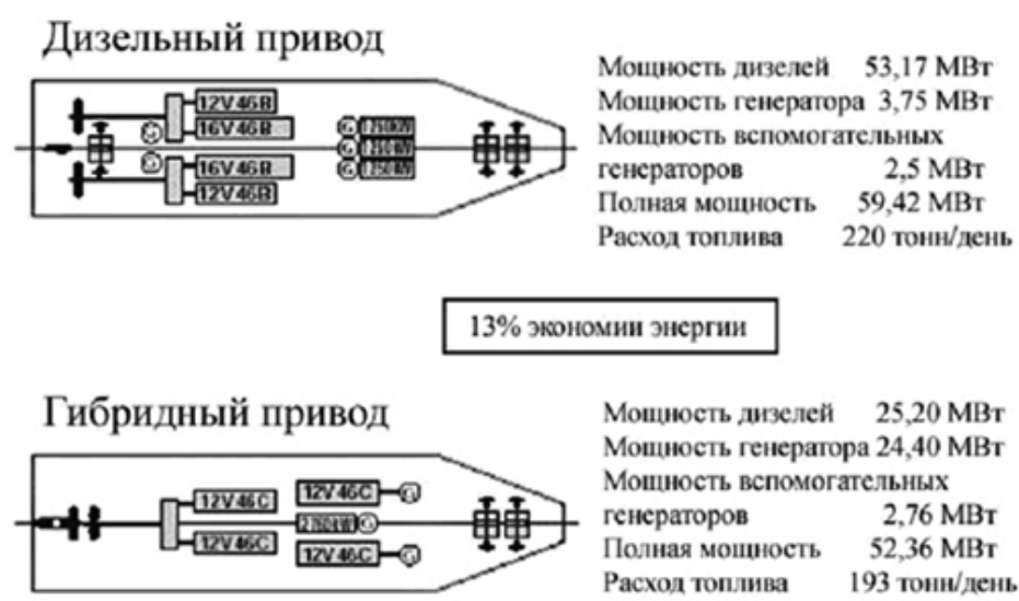
Рис. 1. Сопоставление гибридной и традиционной схем судовых силовых установок
