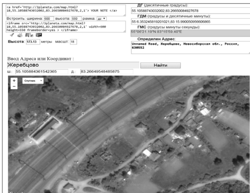
Рис. 3. Определение высотных отметок с использованием цифровых спутниковых снимков высокого разрешения
