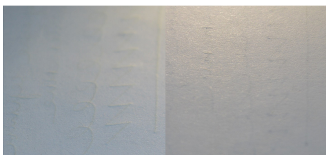
Рис. 7. Слева – обратная сторона листа А4 с штрихами шариковой ручки Erich Krause R-301 в косопадющем освещении. Справа – обратная сторона того же листа со штрихами гелевой ручки BIC Gel-ocity (синей) в косопадющем освещении. Более выраженный рельеф на правом изображении является следствием большего нажима (позитивный след борозды), который прикладывается при письме к шариковой ручке по сравнению с гелевой
