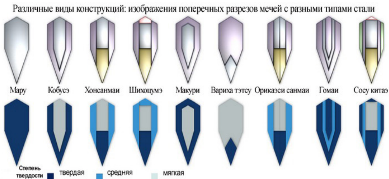
Рис. 2. Изображения поперечных разрезов мечей
