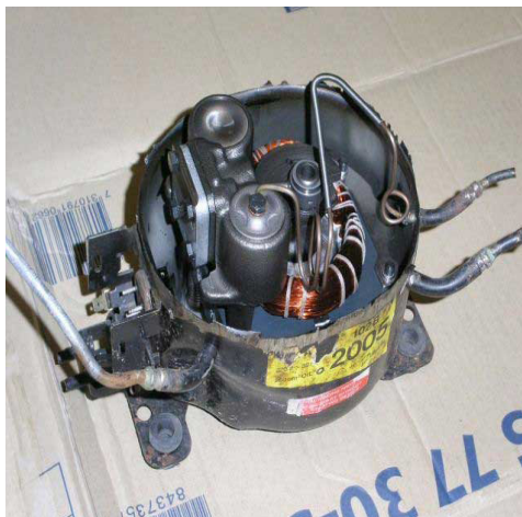
Рис. 1. Холодильник полностью разбирается, снимается с него компрессор вместе со всеми проводами
