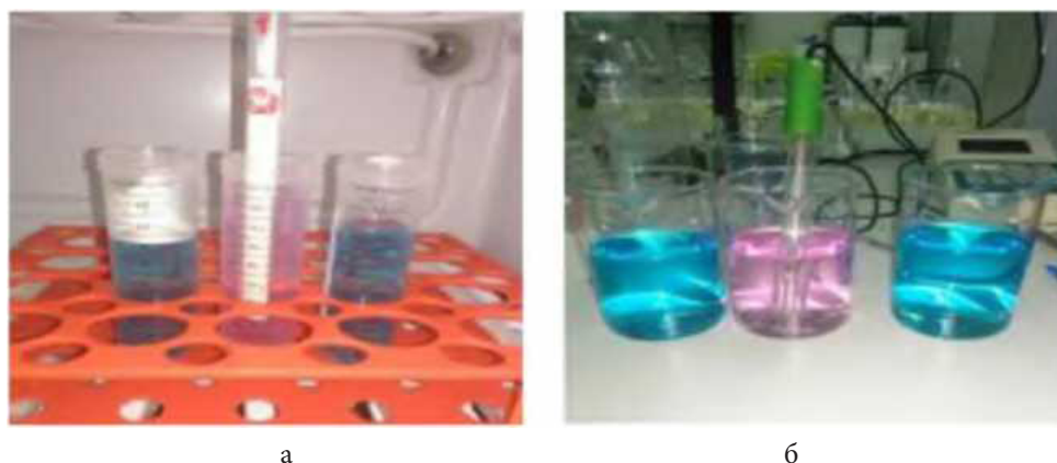
Рис. 1. Определение стеклоомывающих низкозамерзающих жидкостей: а — температуры замерзания; б — водородного показателя
