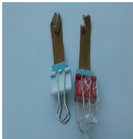
Рис. 2. Место контакта после разрыва клеевого соединения
