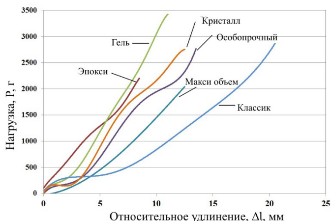
Рис. 3. Прочность клеевого соединения для различных составов
