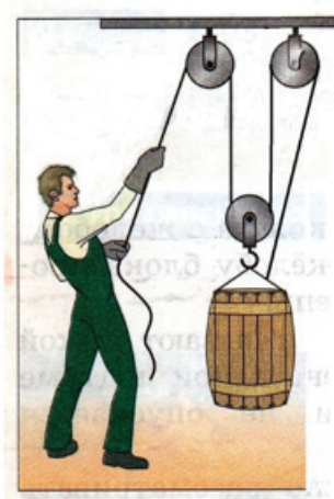
Рис. 13 (изменённый рис. 181). Выигрыш в силе 3 раза.
