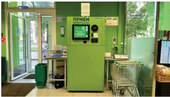
Рис. 4. Автомат по сбору пластиковых и алюминиевых бутылок, г. Санкт-Петербург
