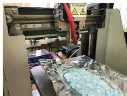
Рис. 3. Создание смеси на 3D принтере. а — работа автора на 3D-принтере; б — обволакивание волокна смесью пластика и разбавителя; в — формирование ткани на фольге; г — сушка готовой ткани
