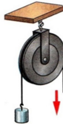
Рис. 20. Неподвижный блок [5, с. 177]
