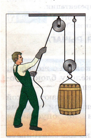
Рис. 18. Выигрыш в силе 2 раза [5, с.178]
