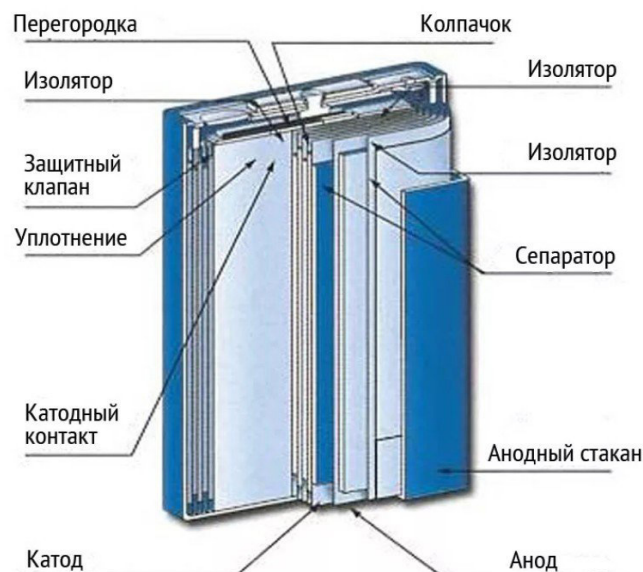
Рис. 2. Устройство литийионного аккумулятора
